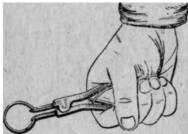
Фиг. 6. Щипцы для снятия стопорных колец первичного вала и ступицы синхронизатора.
