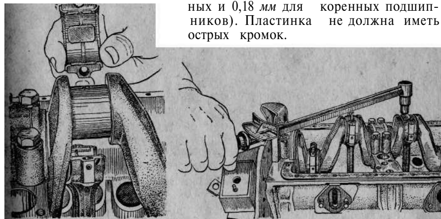
Фиг. 6. Затяжка гаек крышки шатуна при помощи динамометрического ключа.
