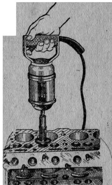
Фиг. 20. Шлифование седла ВПУСКНОГО клапана.
