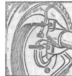
Фиг. 65. Пресс-масленки шкворня передней ОСИ.
