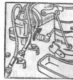
Фиг. 58. Колпачковая масленка для смазки валика распределителя.
