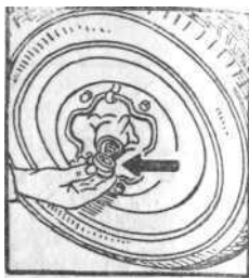
Фиг. 62. Место смазки подшипника переднего колеса.
