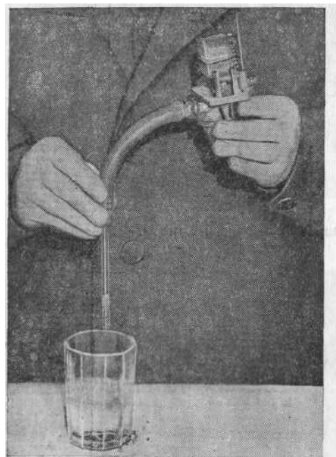
Фиг. 80. Проверка герметичности игольчатого клапана карбюратора.
